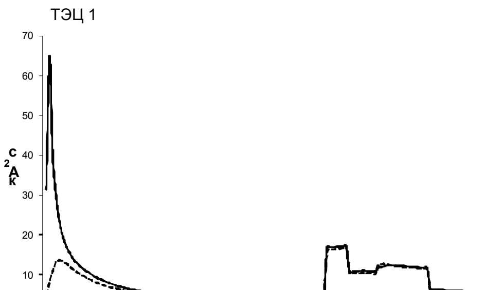
Рисунок А.7 Изменение термического воздействия на ГТ при перемещении КЗ вдоль ВЛ при двухфазном КЗ на землю
