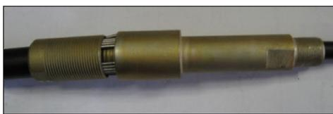
**11** Надвинуть втулку с наружной резьбой на проволоку брони, надвинуть на ОК штуцер и продвинуть его к втулке.
