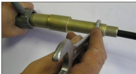
**14** Навернуть штуцер на корпус до упора, используя ключ  $S=19$  мм и ключ  $S=36$  мм. Надвинуть на втулку с наружной резьбой наконечник.
