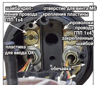
**20** Закрепить ЦСЭ обоих ОК в узлах крепления ЦСЭ на обратной стороне кассеты для ОК (между скобой и пластиной) с помощью гаек, пользуясь торцовым ключом  $S=10$  мм.
