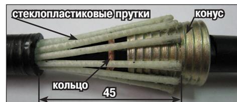
**13** Удерживая втулку с наружной резьбой специальным ключом  $S=24$  мм (ключ для монтажа муфт типа МТОК), навернуть штуцер до упора на втулку с наружной резьбой, после чего затянуть штуцер ключом гаечным  $S=19$  мм.
