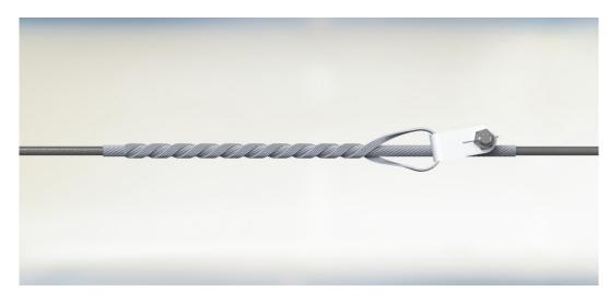
Маркировка зажимов HCO-15-Dmin/DmaxП HCO — зажим натяжной спиральный; 15- предназначен для кабелей с нагрузкой до 15 кН Dmin/Dmax — наименьший/наибольший диаметр оптического кабеля, мм; П — наличие протектора;
