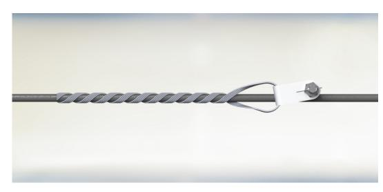
Маркировка зажимов HCO-8-Dmin/Dmax,HCO-8-Dmin/DmaxK HCO — зажим натяжной спиральный; 8- предназначен для кабелей с нагрузкой до 8 кН Dmin/Dmax — наименьший/наибольший диаметр оптического кабеля, мм; K-коуш
