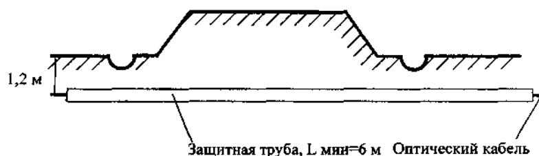
Рисунок В.1 - Прокладка ОК через автомобильную дорогу
