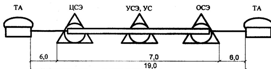
Рисунок Б.10 - Распределение норм затухания на СТС при двухступенчатом радиально-узловом построении, лист 1
