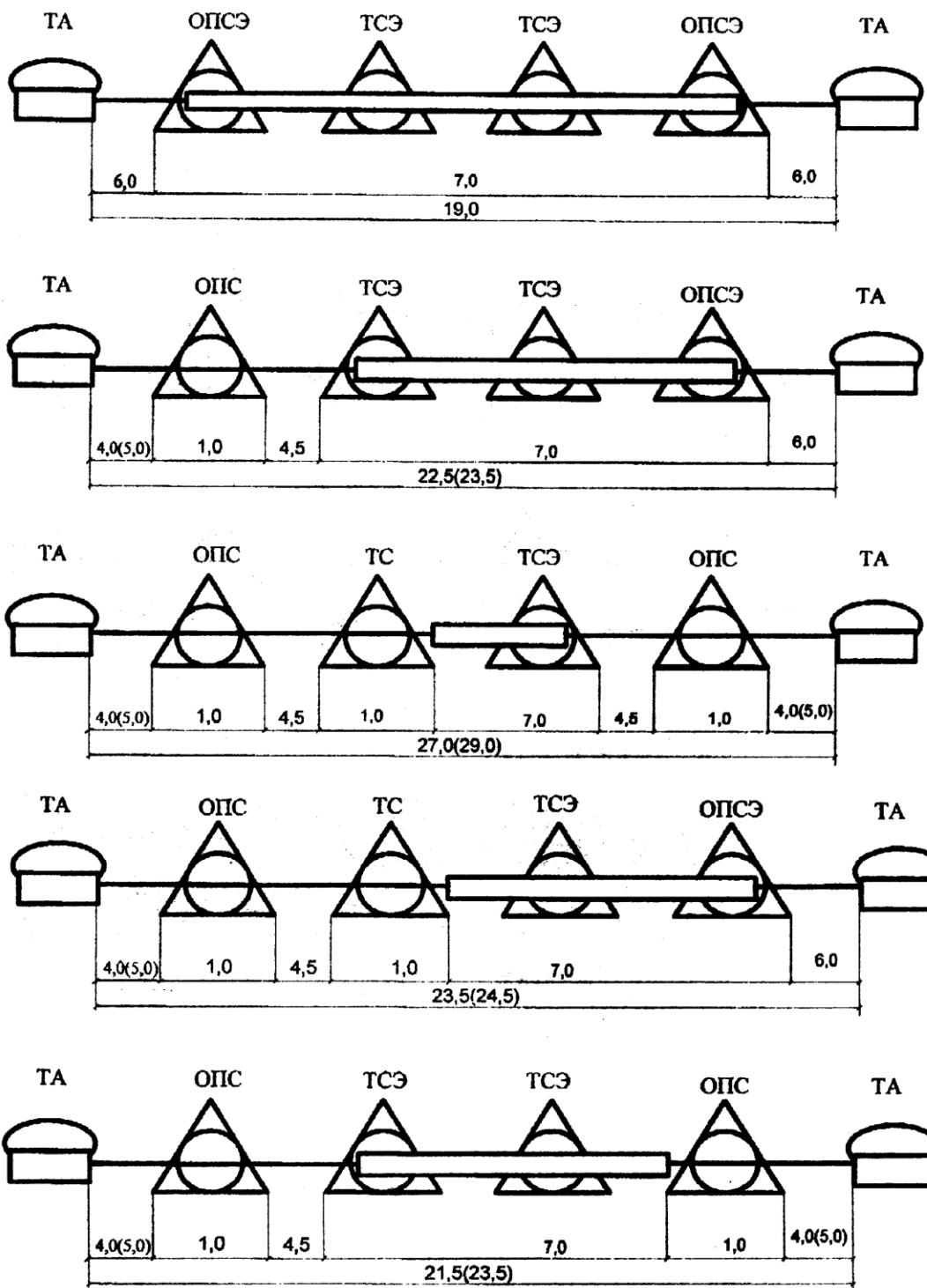
Рисунок Б.5 - Распределение норм затухания на районированной ГТС с узлами исходящего и входящего сообщения, лист 1
