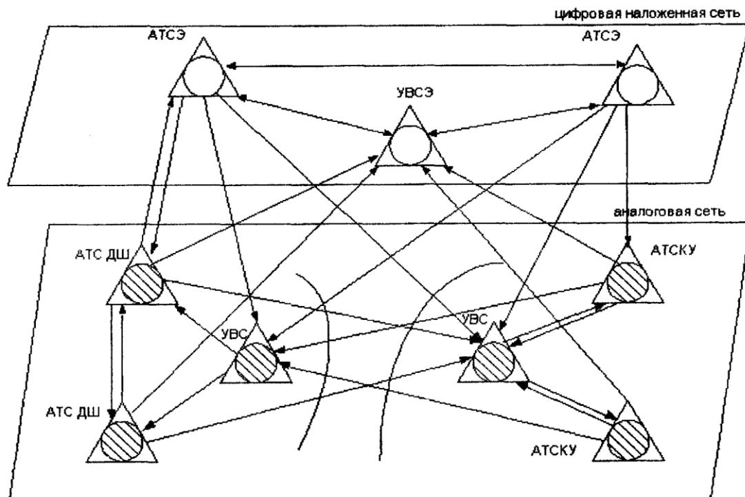
Рисунок 6.2 - Структура аналого-цифровой сети с узлами входящих сообщений
