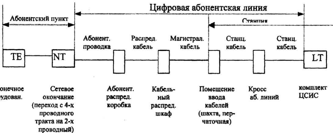
Рисунок 9.1 - Структура цифровой абонентской линии с ЦСИС (АЛЦ) 2В+Д.
