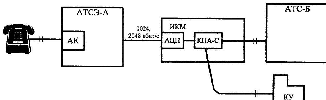
Рисунок 6.6. Реализации на АТСЭ абонентского (КПА-А) и станционного (КПА-С) окончаний для подключений прямого абонента
